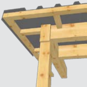
Profilblechdach (Dachneigung ca. 5%)
