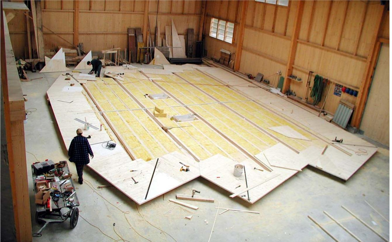
Flachdach mit Plattenverkleidung bei der Produktion im Werk.
